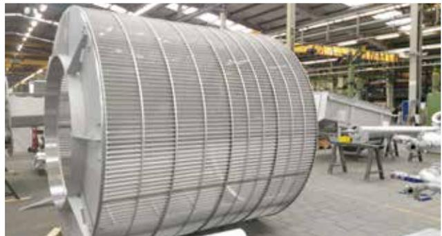
ROTAMAT® STAR Siebkorb mit 2600 mm Durchmesser und 1 mm Lochweite. Gebeizt und im Vollbad passiviert.
