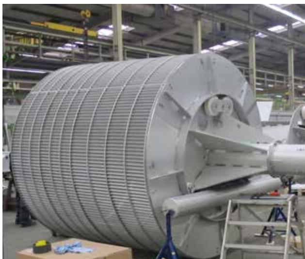
HUBER Siebanlage ROTAMAT® STAR mit Durchmesser 2600 mm mit 1 mm Lochdurchmesser.
