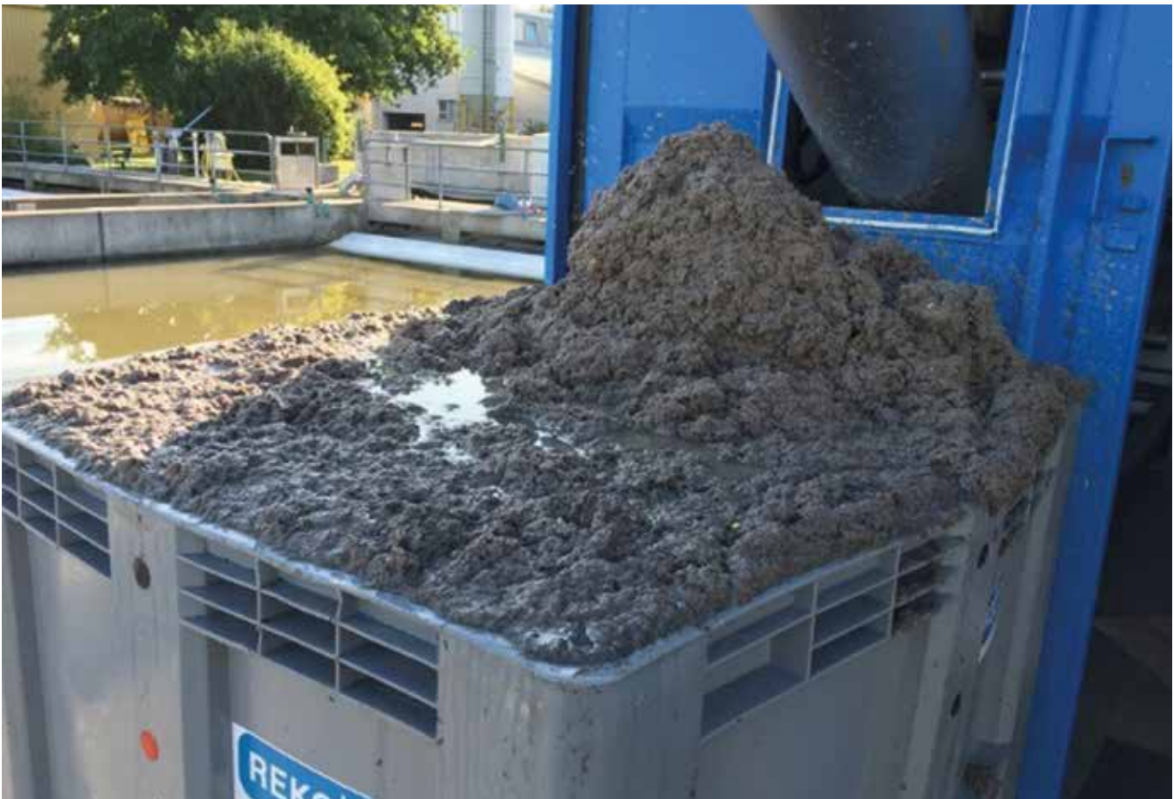
Vom HUBER Trommelsieb LIQUID Mesh abgeschiedenes Siebgut: Die biologische Stufe ist dadurch entlastet und im Faulbehälter kann damit mehr Gas produziert werden.
