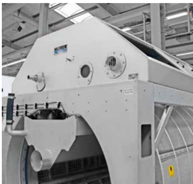
Polyurethanabdichtung im Zulauf des HUBER Trommelsiebes für konstante, sehr hohe Abscheideleistungen.
