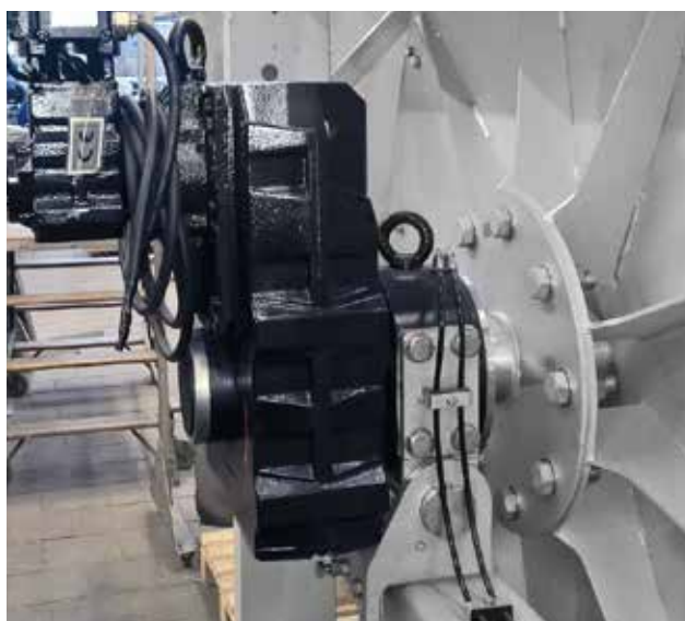
Direktantrieb mit einzigartiger, selbstjustierender Lagerungseinheit für maximale Verfügbarkeit.
